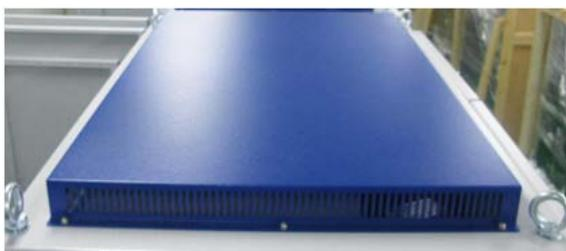
Foto 41: Copertura superiore dell'inverter
